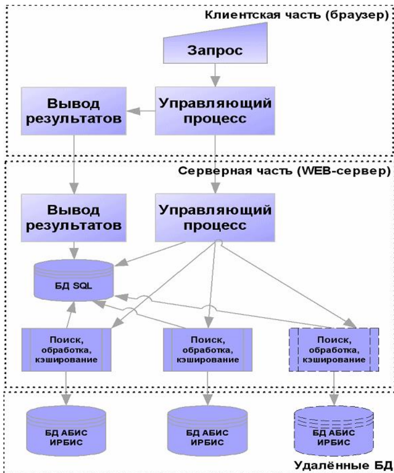
Рис. 114 - Принципиальная схема поисковой системы
